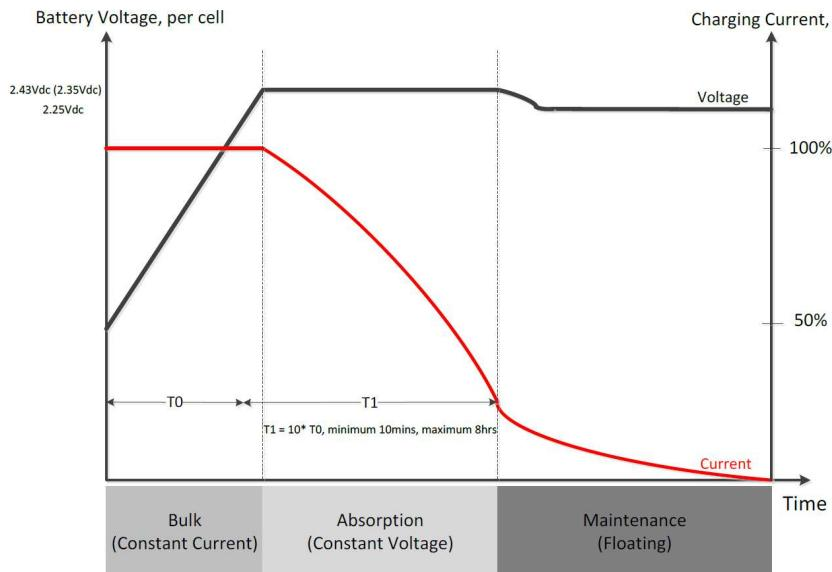
Punjač poseduje tri nivoa punjenja baterija i to "bulk" (punjenje konstantnom strujom), "absorption" (apsorpcija - punjenje sa konstantnim naponom) i "floating" (plivajući režim - održavanje). Pored toga, invertor dozvoljava podešavanje raznih parametara kao što su nivoi napona punjenja baterija, prioriteti izvora punjenja, nizak napon isključenja potrošača, prelazak na mrežni izvor... Zahvaljujući tome, sistem može da radi u najoptimalnijim uslovima što je preduslov za dug životni vek sistema.
